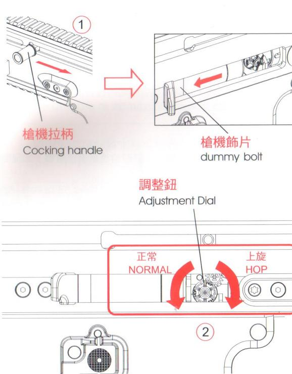
① 將槍機拉柄向後拉，可將槍機飾片固定在後。
