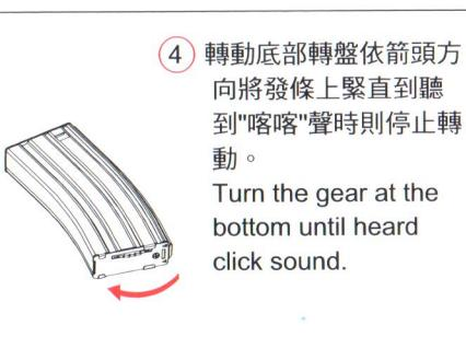
4 轉動底部轉盤依箭頭方向將發條上緊直到聽到"喀喀"聲時則停止轉動。
