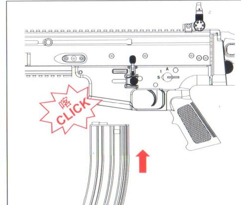
5 正確將彈匣向上插入彈匣口連接牢固直到聽到"喀"一聲。
