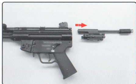
注意若要将槍機組組合回去,首先要將下槍身定位(擊鎗下壓),否則若槍機先進入時連發桿會卡死
