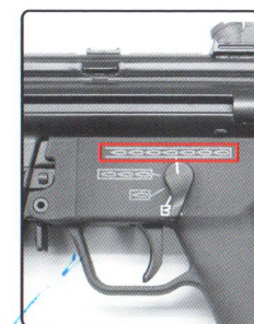
自動射擊模式 Full-Auto Mode 扣住扳機不放,子彈會連續發射。
